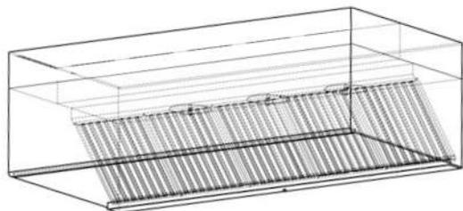
Estructura tubular consiguiendo mayor robustez del conjunto. Se puede fabricar en cualquier fondo que sea necesario para la instalación. Asimismo, es posible si la instalación lo requiere, acoplar un plenum para mejorar la distribución de la aspiración.
