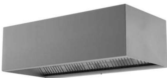
Campana soldada y construida en una sola pieza hasta 7 m de longitud, reduciendo así el tiempo de montaje y deformaciones lineales. Se eliminan los goteos entre juntas, y puntos no visibles de suciedad. La bandeja inferior, totalmente soldada está incorporada al conjunto sin posibilidad de goteos. Recoge grasas perimetral conectado a la bandeja inferior.
